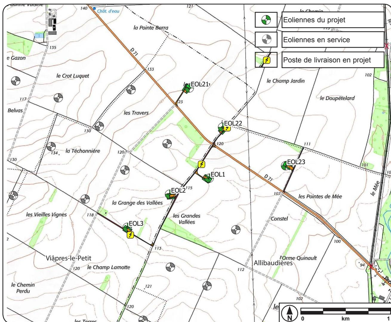
Ce projet porte sur la construction d'une ferme éolienne sur les communes de Viâpres-le-Petit et Allibaudières dans le département de l'Aube. Elle sera composée de 6 aérogénérateurs destinés à la production d'électricité et de trois structures de livraison nécessaires à l'exploitation. L'installation vient en extension directe des parcs éoliens existants des Renardières (Est) et Champ Fleury (Ouest)
